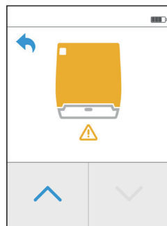
Siebfilter bald warten lassen
